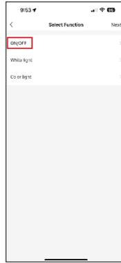
Au cours de cette étape, toutes les fonctions que l'appareil peut effectuer s'affichent. Pour les lampes, ce sont les réglages comme On/Off, réglage de la luminosité, minuteur, couleurs... Pour d'autres appareils, d'autres fonctions plus complexes peuvent s'afficher, comme par ex. l'activation du chauffage, le réglage de la température, l'ouverture des persiennes et beaucoup d'autres.
