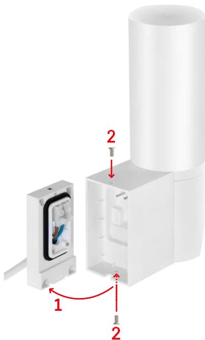
Instale a unidade de câmara no suporte (suporte de instalação). Aparafuse a unidade de câmara com os parafusos.
