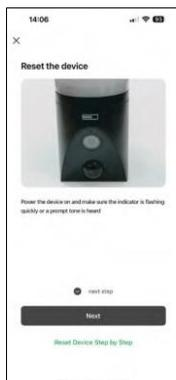
Ligue o dispositivo ligando-o à corrente e certifique-se de que o LED de estado está a piscar a vermelho. Se o LED não estiver a piscar, reinicie o dispositivo utilizando o botão RESET.
