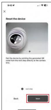
Accendere e resettare la telecamera utilizzando il pulsante RESET sul fondo della telecamera e continuare con l'applicazione. Dopo un reset riuscito, l'indicatore dovrebbe lampeggiare rapidamente.
